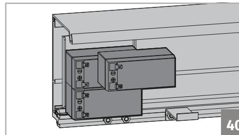
40. Intercambie las baterías, coloque la chapa sobre ellas y vuelva a apretar los 2 pernos.
