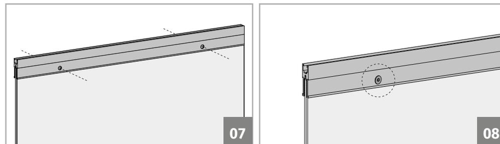
**07.** Alinee los agujeros del vidrio con los agujeros ya existente en la pinza. Esta operación no debe ser realizada solo encima de un soporte de protección (cartón).
