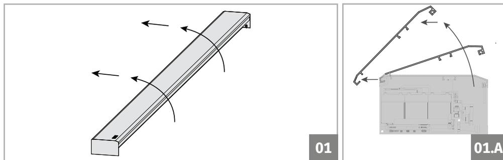
**01.** Coloque el cofre sobre un material protector (cartón). Levante la tapa del cofre y hágala deslizar para el frente para que esta desencaje, como ilustrado en el **DETALLE (01.A)** arriba. Retire todos los componentes sueltos de dentro del cofre como los accesorios de fijación, receptores y carros de arrastre.
