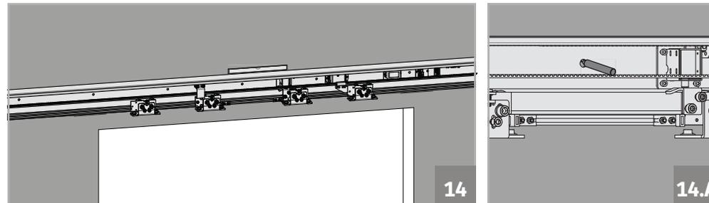
**14.** Junte el cofre a la pared y, utilizando material para marcar, haga las marcaciones en los locales exactos donde agujereó el cofre. Mantenga la atención al nivelamento del cofre cuando esté haciendo las marcaciones.
