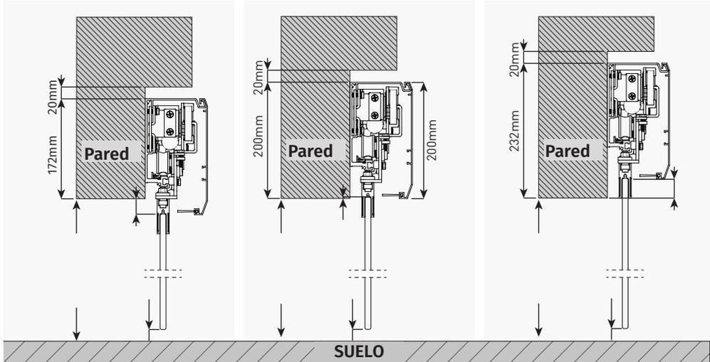
**Modo visible** • Pinza de fijación del cristal será visible desde el exterior (192mm de Dintel mínimo).
