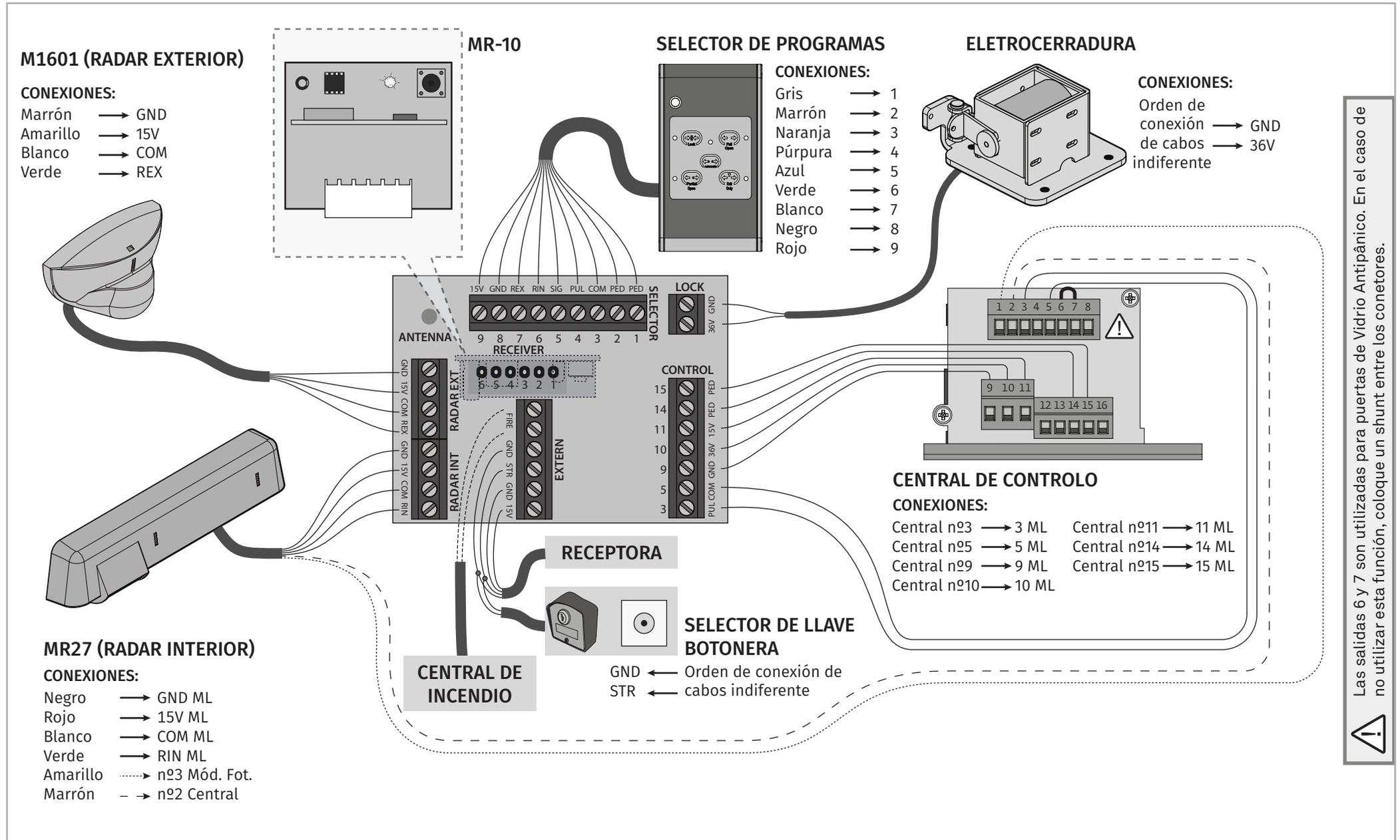
Las salidas 6 y 7 son utilizadas para puertas de Vidrio Antipánico. En el caso de no utilizar esta función, coloque un shunt entre los conectores.
