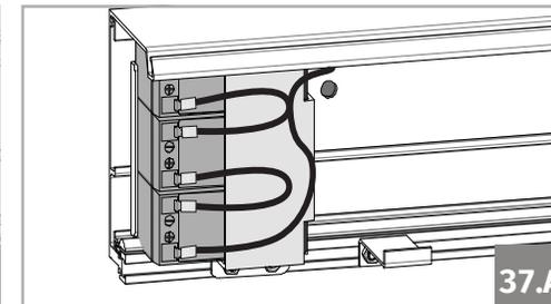
37. Después de probar todos los componentes, conecte las baterías colocando el cable que se encuentra suelto.
