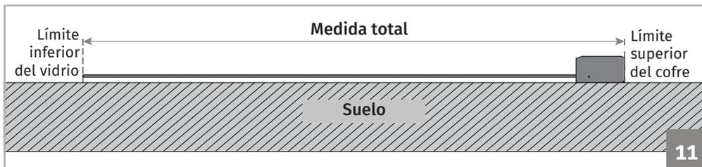
**11.** Aún en el suelo, junte el vidrio (ya con la pinza colocada) al cofre. Quite la medida total entre a límite inferior del vidrio al límite superior del cofre. Tenga la atención al nivelamento.
