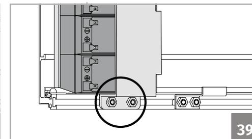
38. Desconectar los cables que conectan las baterías.
