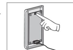
**02** • Con el selector conectado, presione el botón RESET existente en la placa durante 40seg.
