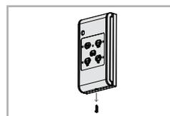
**01** • Desapriete el tornillo de la tapa (por debajo del selector) y retire el panel posterior.
