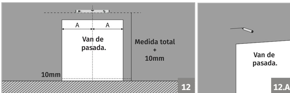
**12.** Transporte y centre la medida total, para el local donde será aplicada la puerta, utilizando un lápiz o marcador. Aumente 10mm la medida total, dejando así un margen para que el vidrio no entre en contacto con el suelo. Haga un mínimo de dos marcaciones, teniendo siempre atención a la nivelación del automatismo.
