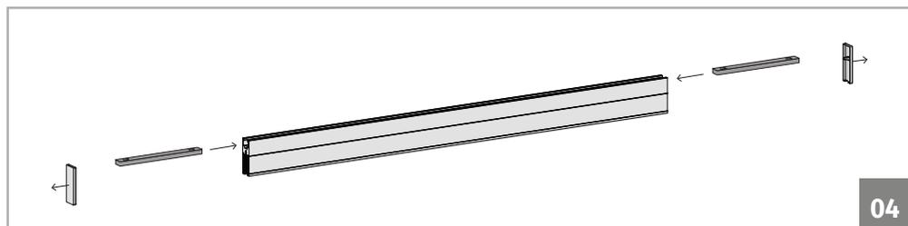
**04.** Retire las tapas de la pinza y coloque las chapas que se encuentran en el kit (cada pinza necesita dos o tres chapas dependiendo del tamaño de la hoja).
