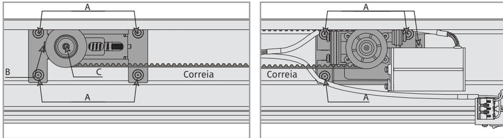
**Atención:** Primero compruebe el apriete de los tornillo (A). Estos tornillos mantienen los alargadores de las correderas fijas. Si estos tornillos pierden fuerza, la correa pierde tensión.
