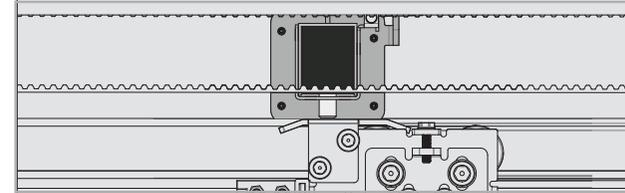
Después de accionada (puerta cerrada), la electrocerradura podrá ser desbloqueada jalando la palanca de seguridad para abajo.
