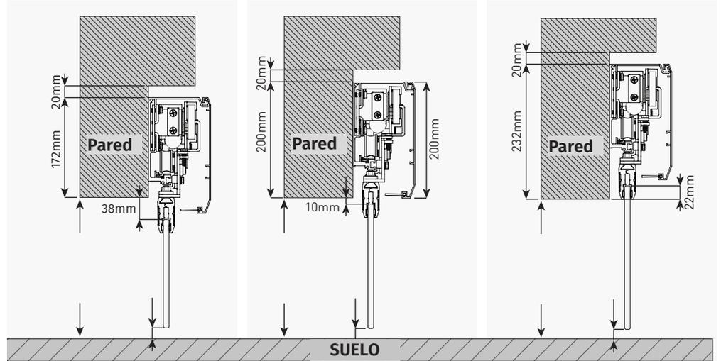
**Modo visible** • Pinza de fijación del cristal será visible desde el exterior (192mm de Dintel mínimo).
